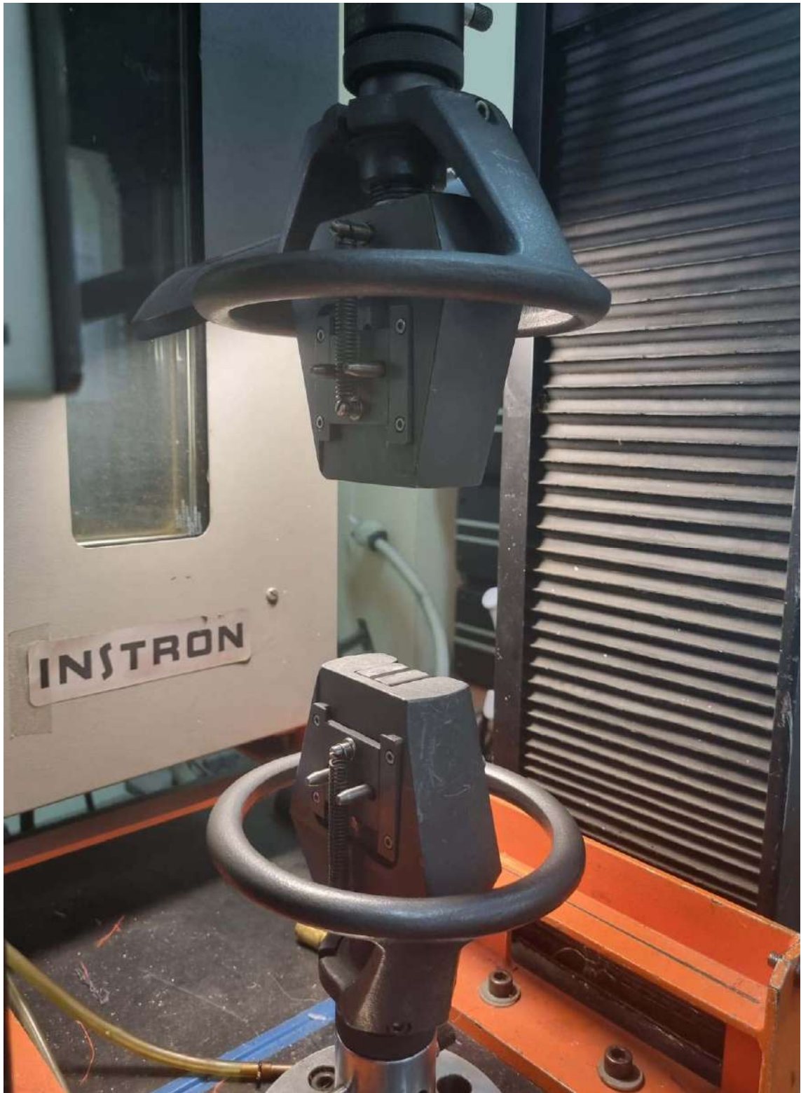
Рисунок 2.2 - Зажимы разрывной машины "Instron - 1122" для фиксации исследуемого АТМ
