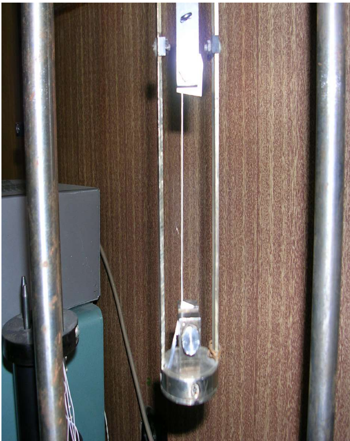
Рисунок 2.9 - Проведение исследования АТМ на приборе "релаксометр напряжений" центра коллективного пользования СПбГУПТД в режиме релаксации
