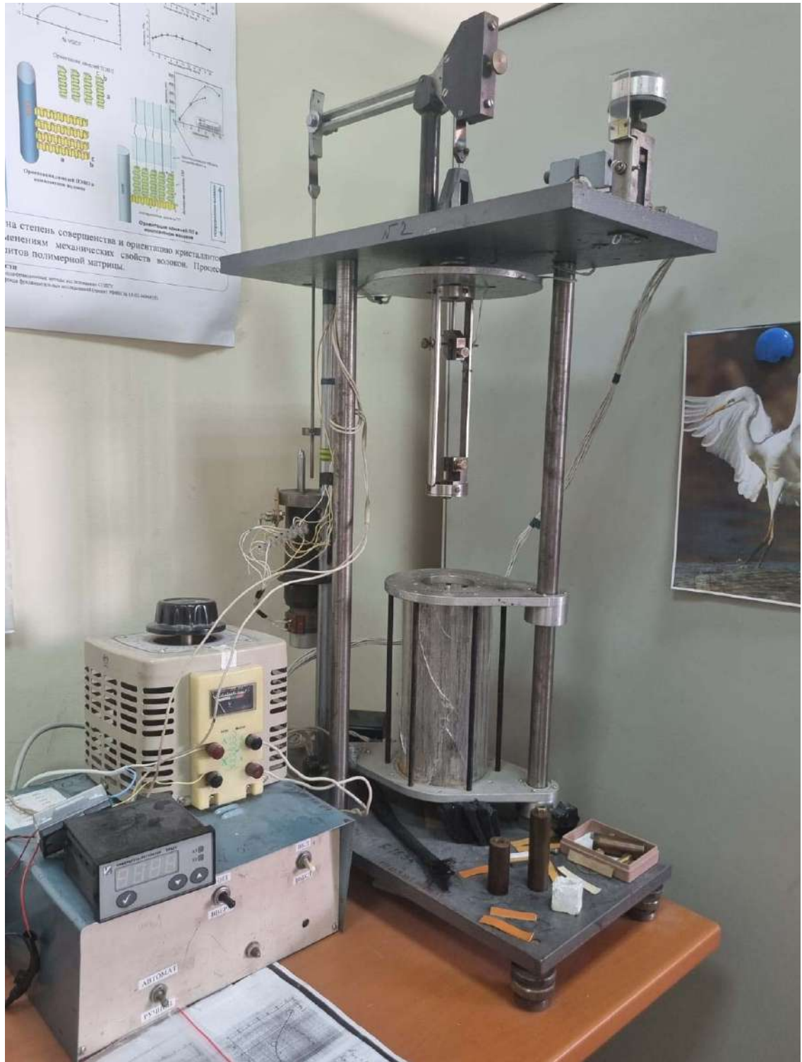
Рисунок 2.10 - Прибор "релаксометр деформаций" центра коллективного пользования СПбГУПТД для проведения испытаний АТМ в режимах ползучести
