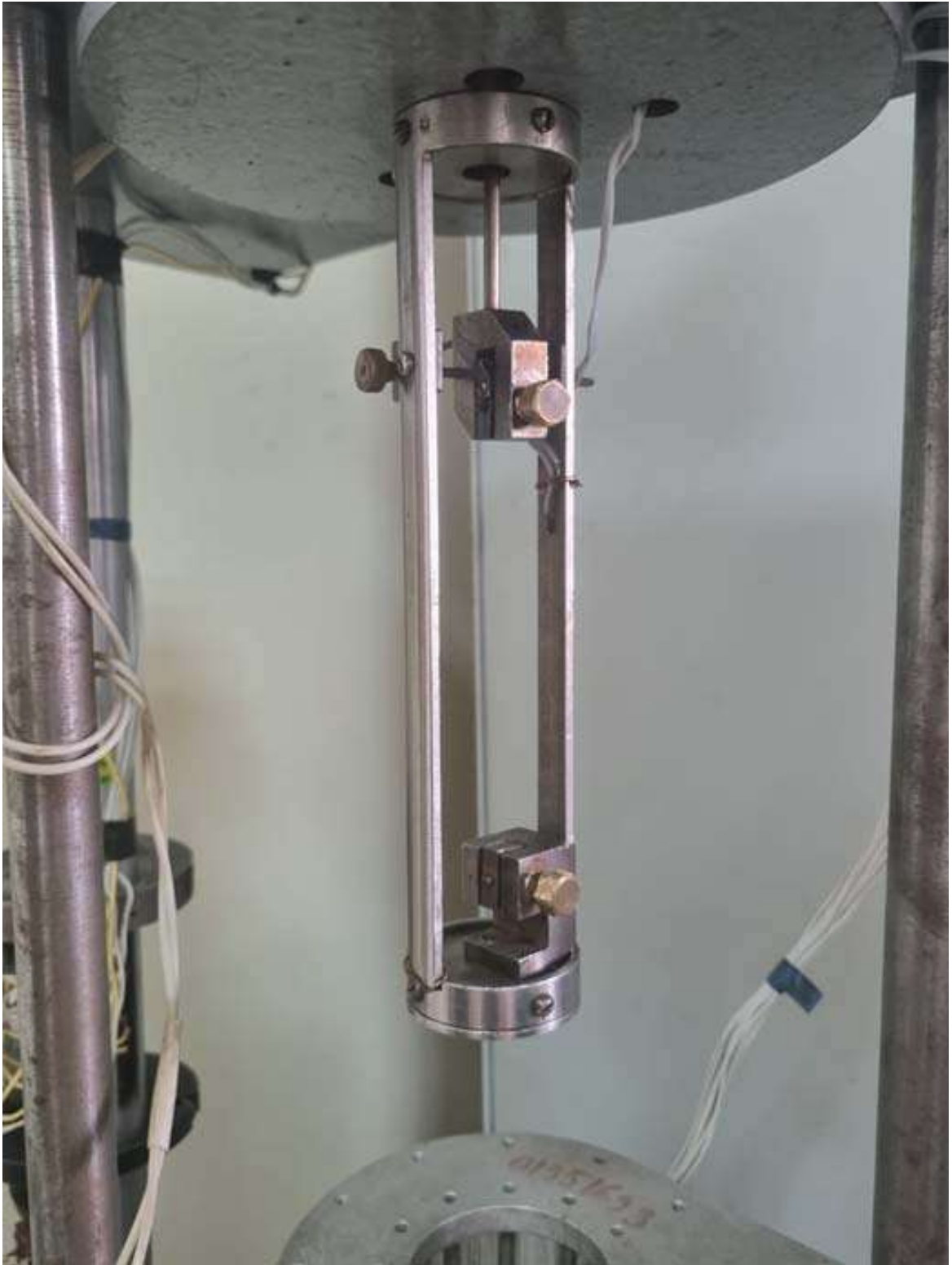
Рисунок 2.11 - Проведение исследования АТМ на приборе "релаксометр деформаций" центра коллективного пользования СПбГУПТД в режиме ползучести
