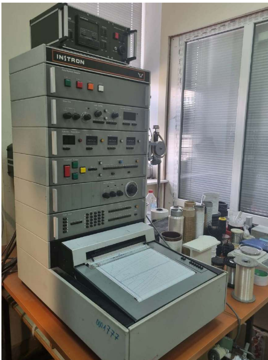
Рисунок 2.3 - Снятие показаний с разрывной машины "Instron - 1122" при проведении эксперимента в режиме процесса растяжения АТМ с постоянной скоростью деформирования
