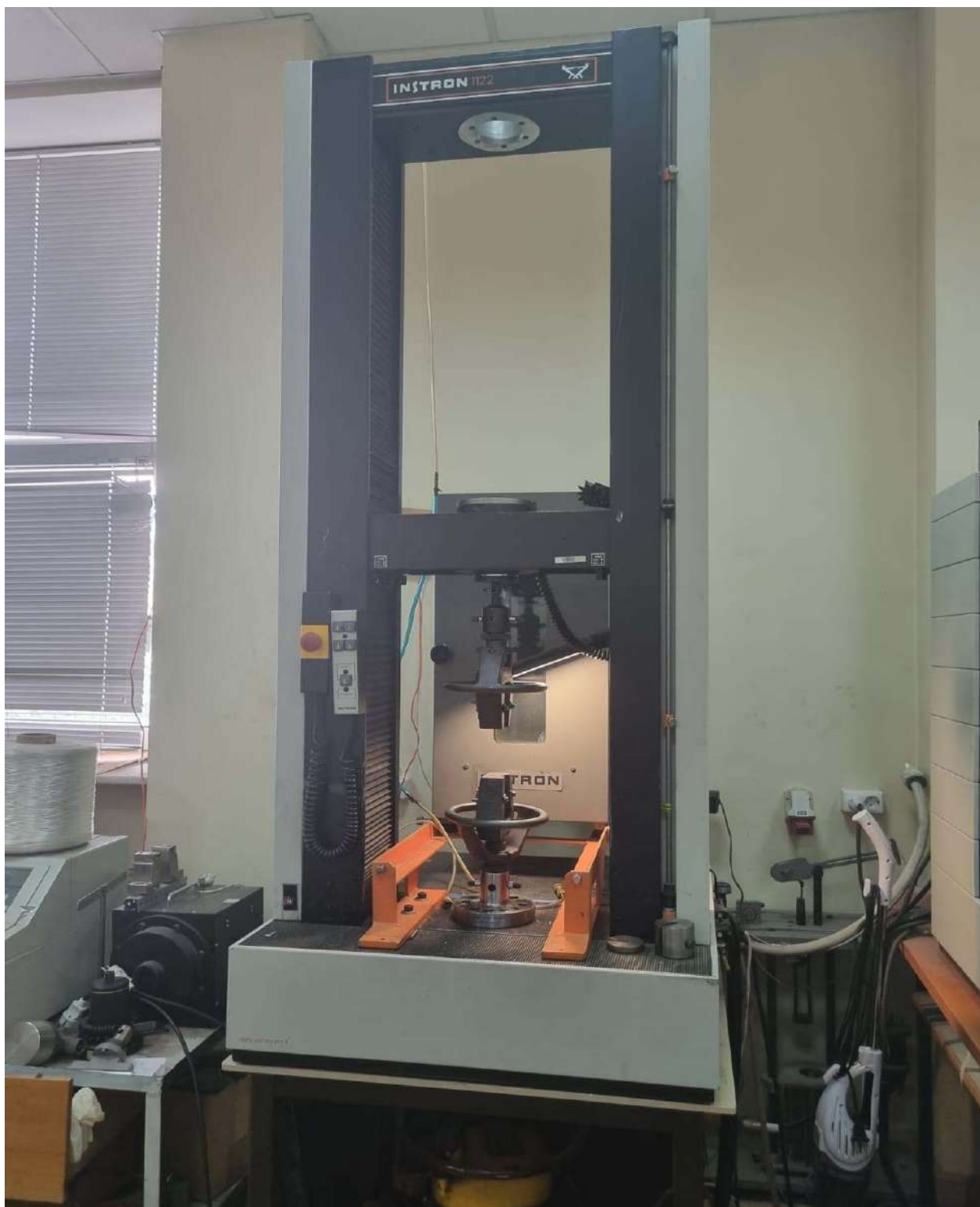
Рисунок 2.1 - Разрывная машина "Instron - 1122" для экспериментальных исследований АТМ в режимах растяжения с постоянной скоростью деформирования
